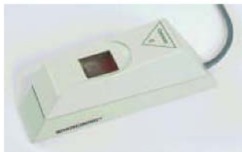
Abb.7: Sensor Optiscan II der Firma Morphosoric ®
