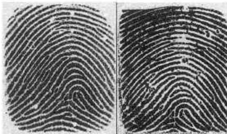
Abb.33: Aufnahme eines Fingers und des zugehörigen Gummifingers, erstellt mit einem kapazitiven Fingerabdrucksensor der Infineon Technologies AG
