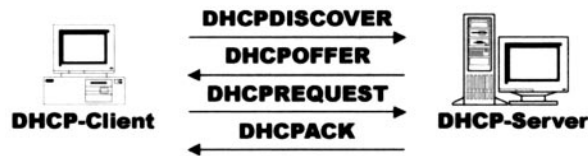
Abbildung 2-15 „Während der ersten Anforderung einer Lease ausgetauschte DHCP-Nachrichten“ [LEE00]
