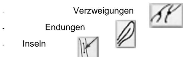
Wie in Abbildung 6 gezeigt, kann ein Muster aus Minutiae gebildet werden. Dieses am häufigsten verwendete Verfahren benötigt eine Sensorauflösung von ca. 500 dpi [Veridicom99]. Die Minutiae werden über Vektoren miteinander verbunden und nur das resultierende Muster wird gespeichert und für den Vergleich verwendet. Für eine juristisch eindeutige Identifikation einer Person sind zwölf Minutienpaare ausreichend.
